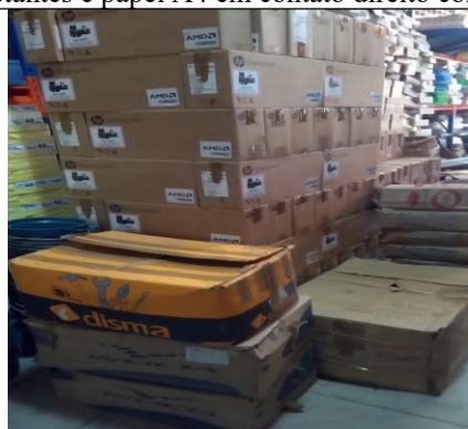
Materiais armazenadas em contato direto com o piso.
